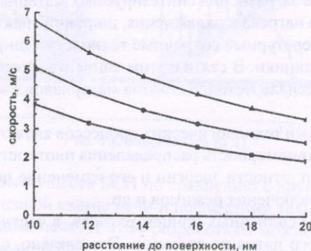
Рис. 2. Зависимость скорости воздушного потока, очищающего поверхность ФЭБ, от величины заряда частиц (1 - 30e; 2 - 20e; 3 - 10e) диаметром 100 нм и расстояния до поверхности ФЭБ.
