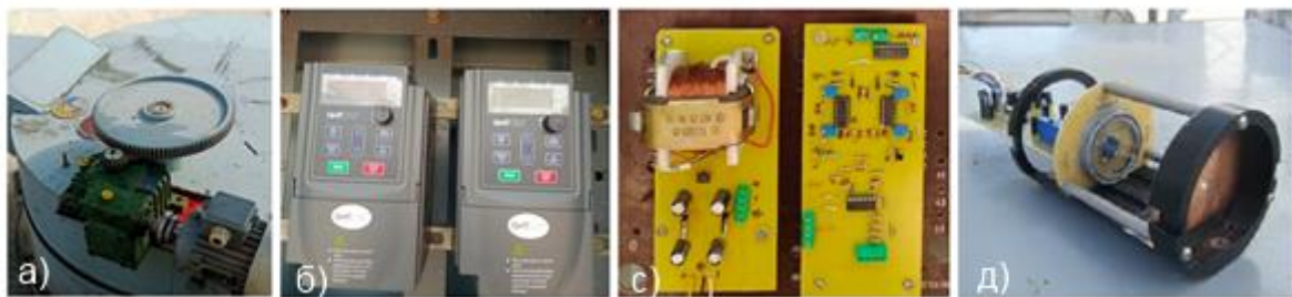
Рис.3. Основные узлы разработанной системы слежения за Солнцем. а). Мотор-редуктор и шестерни вертикальной оси. б). Инверторы вертикальных и горизонтальных осей. в). Блок питания (слева) и плата управления (справа). г). Солнечный датчик (без корпуса).
