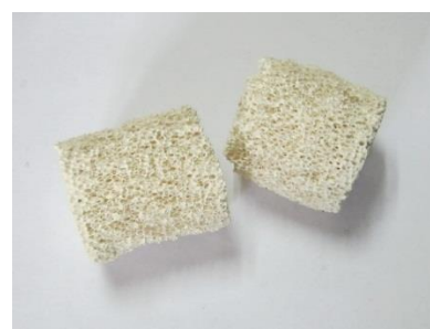
Пористая керамика, полученная методом пропитки полимерного каркаса.
