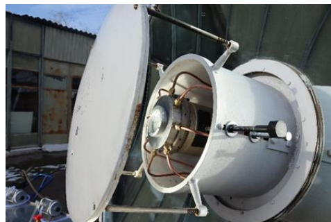
Рис.3. Реактор термохимического производства водорода прототип 1, установленный на солнечном концентраторе
