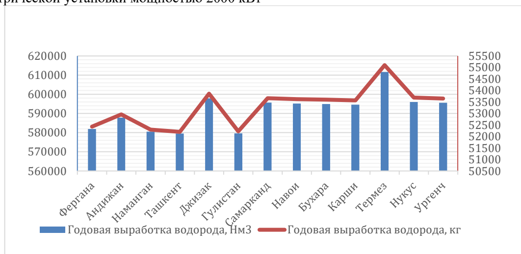
Рис.5 Годовое производство водорода в 13 различных регионах для фотоэлектрической установки мощностью 2000 кВт [7, 10, 12].
