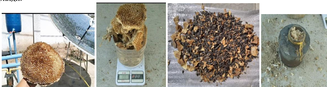
2-расм. Кунгабоқар ўсимлигини пиролиз қилиш жараёни.
