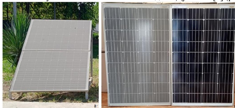
Рисунок 1. Внешний вид испытуемых панелей а) панели с осажденной пылью, б) визуальное сравнение чистой панели и загрязнённой панели.
