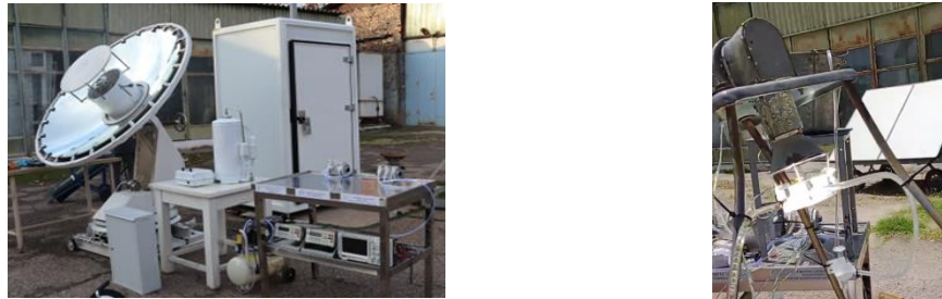
Рис.6. Блок светового проема солнечного термохимического реактора присоединяется к самому реактору, а процесс контроля осуществляется в отдельном концентраторе.
