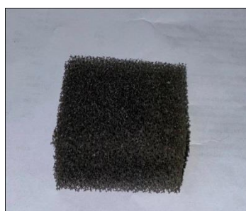
Пенополиуретановая матрица с пористостью 30 ppi
